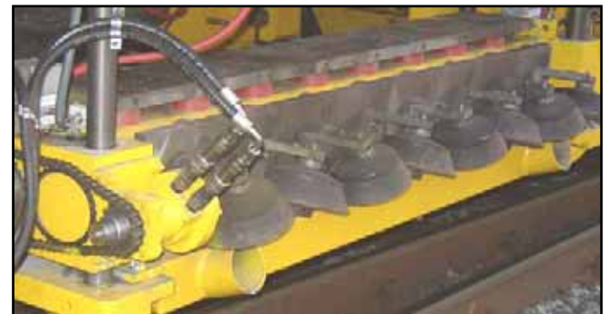
Foto oben: Details einer von acht montierten Schleifeinheiten
