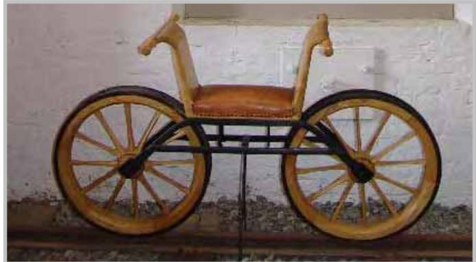
oben: Rekonstruktion einer Gleislaufmaschine nach einem Patent von 1838.
