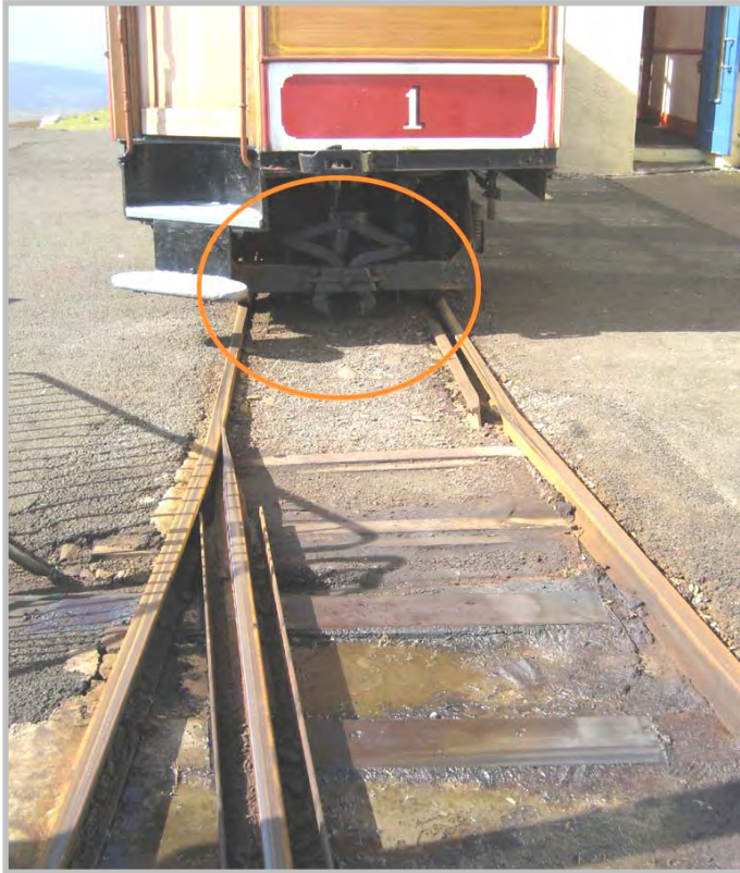
(Foto oben: Detailsicht der Zangenbremse, im Vordergrund ist als weitere Besonderheit, eine der Einzungenweichen zu erkennen.)
