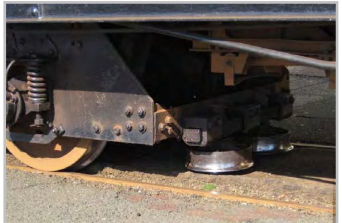
(Foto oben: Detailansicht der horizontalen Fell-Antriebsräder am Triebwagen 1.)
