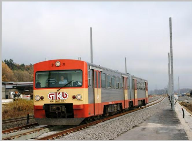
Foto oben: Gegen Mittag lichtete sich der Nebel etwas und so konnte der VT 70.10 als R 8561 auf der Fahrt nach Wies-Eibiswald auf der neuen Weiche 58 fotografiert werden. Da sie eine Schnellfahrweiche ist, besitzt sie ein bewegliches Herz.
