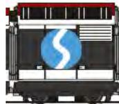
Diese Grundversion (GTW 2/6) kann durch Einfügen eines zusätzlichen Mittelwagens (siehe Abb.) an einer Seite des Antriebsmoduls zum Modell GTW 2/8 erweitert werden. Diese Variante (Endmodul – Antriebsmodul – Mittelwagen – Endmodul) wurde auch von der GKB ausgewählt und sieht dann etwa so aus, wie auf der Skizze ganz unten dargestellt.
