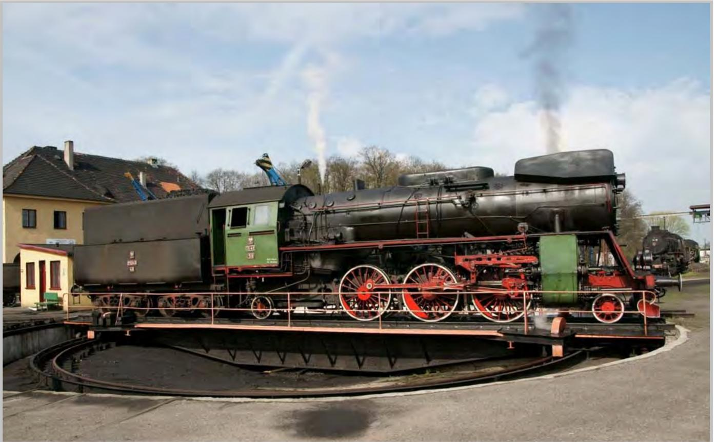
Foto oben: Während der Mittagszeit wird die 0149-59 auf der Drehscheibe im Bw Wolsztyn gedreht. Dabei kommt die Bauart dieser Lok besonders zur Geltung. Von dieser Reihe wurden von 1949 bis 1955 insgesamt 115 Loks in Polen gebaut, ihre Höchstgeschwindigkeit beträgt 100 km/h.
