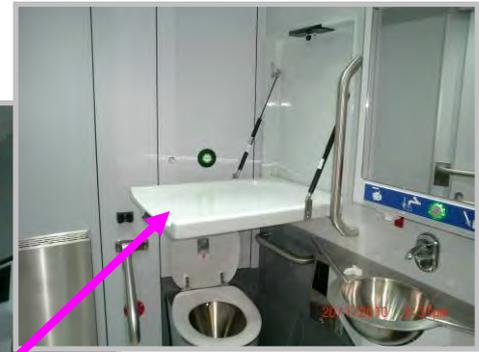
Fotos: Universaltoilette (links) mit ausklappbaren Wickeltisch (Detailaufnahme oben) und Waschtisch (Detailaufnahme unten)
