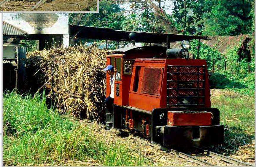
Neben Bahnen mit 600mm sind auch Strecken mit 700mm Spurweite (niederländische Standardfeldbahnspurweite) und 750mm vorhanden.
