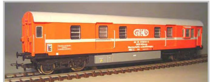
Aluminiumblech. Das Fahrgestell wurde aus einem verlängerten Kleinbahn Postwagen gebaut. Der Gerätewagen wurde aus einem Roco Güterwagen hergestellt. Zusätzlich erhielt dieser Wagen offene Plattformen mit selbstangefertigten Messinggeländern und aufgrund der neuen Wagenlänge ein neues längeres Dach aus Aluminiumblech.
