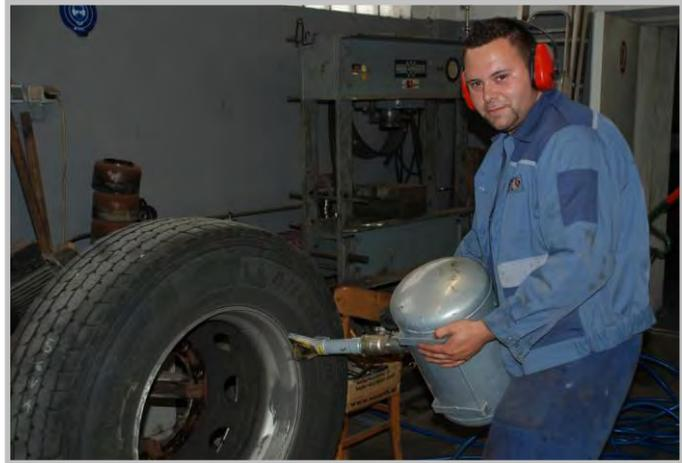
angeschlossen um den vorhandenen Vorratsbehälter zu befüllen. Nach vollständiger Füllung wird der BEAD BOOSTER an die Felge angesetzt und dieser „schießt“, mit geballter Druckluft, den Reifen von der Felge.
