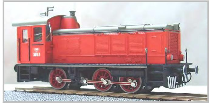
Die „Leitingerlok“ DH 1100.1 (Foto unten) ist nur eine Lackiervariante einer deutschen V100. Es wurden zusätzlich, dem Vorbild entsprechend, die bei der GKB verwendeten Geländer aufgebaut. Die Beschriftung erfolgte mit geschnittenen Folien (vom Schriftsteller), mit Aufreibebuchstaben und mit Decals.
