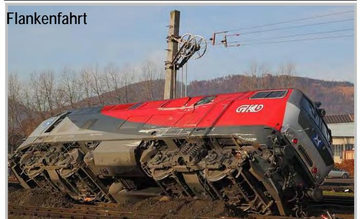
Fatal für die abgestellte 218.256, aber ohne Personenschaden, endete eine Flankenfahrt von Waggons, die sich im nächtlichen Verschluss am Gkf nach einem Kuppelassenbruch selbstständig gemacht hatten, am 4. November 2010. (Foto: Dietmar Zehetner)
