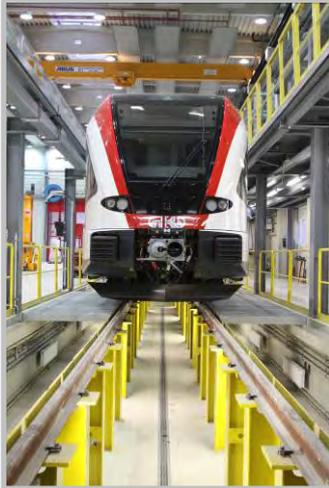
Foto oben: Ein Roll-In einmal anders, hier bei einem ersten Kennenlernen von Fahrzeug und Servicehalle. Ein Stadler GTW auf der dreiteiligen Arbeitsgrube.
