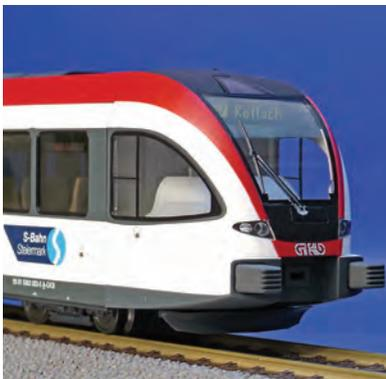
Der Wagenkasten aus Kunststoff ist zweigeteilt, und zwar in den Fahrgastraum und den Führerstand. Das hat natürlich gute Gründe, denn den GTW gibt es beim Vorbild mit unterschiedlichsten Stirnfronten. Der Wagenkasten sitzt auf einem Chassis aus Metall-
