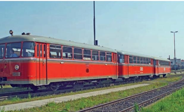
Ein Triebwagen der Baureihe (BR) VT10 - ein Uerdinger Schienenbus - mit zwei Beiwagen am Graz Köflacherbahnhof (I.)
