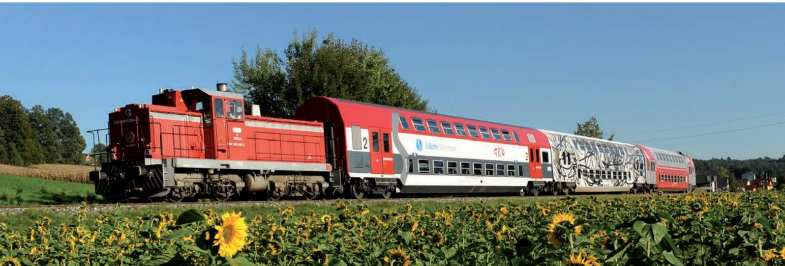
Die Steuerung dieser Diesellok der BR DH1500 - hier als Nachschubtriebfahrzeug eines Triebzuges - erfolgt in diesem Fall im Steuerwagen an der Spitze
