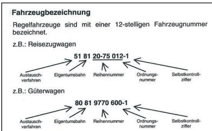
Aufbau der UIC-Wagennummerung: z. B. steht 81 für alle österr. Bahnen
