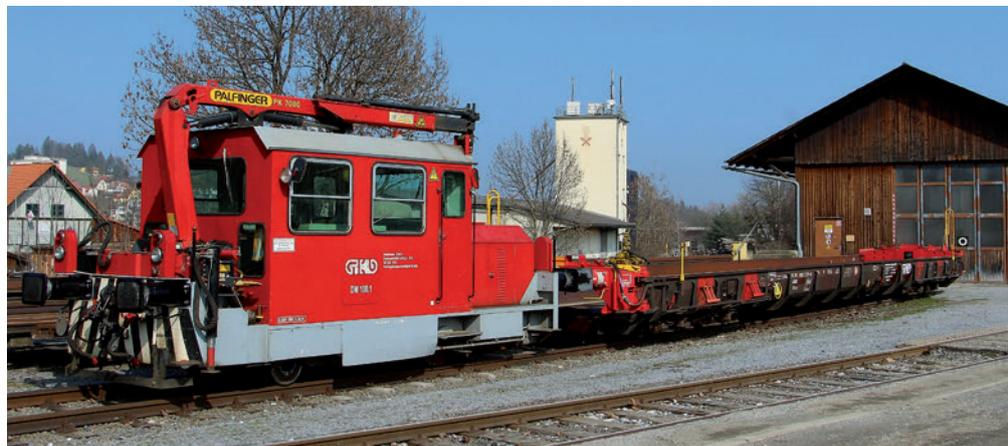
Kleinwagen (DM100.1) m. einem mod. Niederflrwaggon (Saadkms) mit klappbaren Pufferbrüsten
