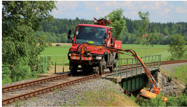
Ein GKB-Unimog als „Schienenfahrzeug“ bei Mäharbeiten am Bahndamm
