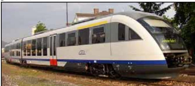
der GKB, nachdem dieser zuvor am Söchauberg ausgiebigst getestet worden war. Der komfortabelst ausgestattete „DESIRO“ in Aluminium Integralbauweise mit diesel - mechanischem Antrieb, 120 km/h zulässiger Höchstgeschwindigkeit, 2 x 275 kW Leistung, 136 Sitzplätzen und 68,2 t Gewicht, verfügt über rollstuhlgerechte WCs und Klimaanlage.
