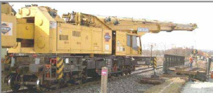
wurde die bestehende Gleisanlage demontiert, die alten Brückenteile in 2 Teile zu jeweils 34 Tonnen und 22 m Länge getrennt und durch den größten Schienenkran Österreichs (siehe Foto links unten) herausgehoben, danach wurden sofort die alten Brückentragwerke abgetragen und der Bahndamm zu den neuen Tragwerken aufgeschüttet.
